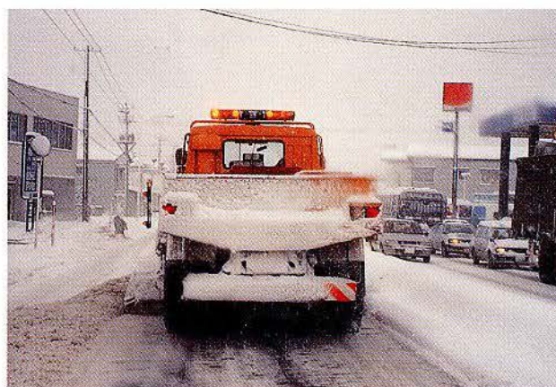
広幅員除雪装置による除雪後の路面状況
