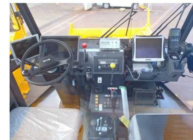
運転室内へ取り付け付けたガイダンス装置
