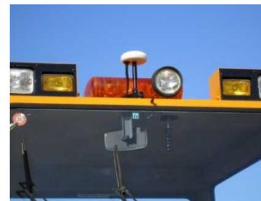
運転室上部へ取り付け付けたGNSSアンテナ
