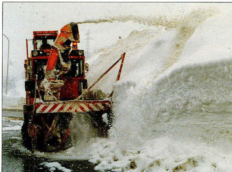
高所運転室による 高雪堤部除雪作業
