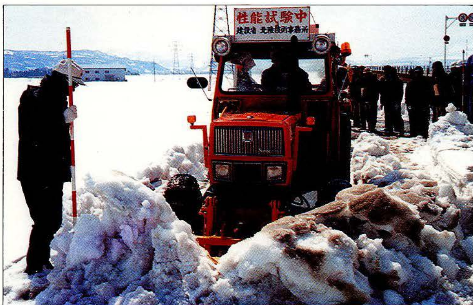
Vプラウ除雪装置による 全巾除雪試験
