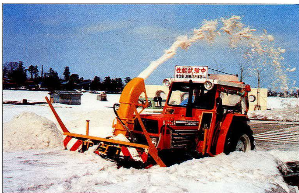
ロータリ除雪装置による 後方投雪試験
