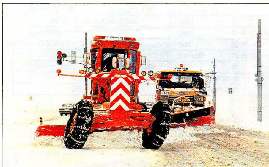
路面整正 除雪トラックと雁行作業
