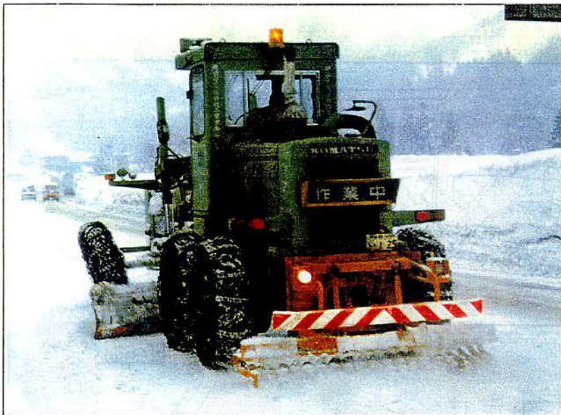
圧雪路粗面形成装置による 現場施工状況
