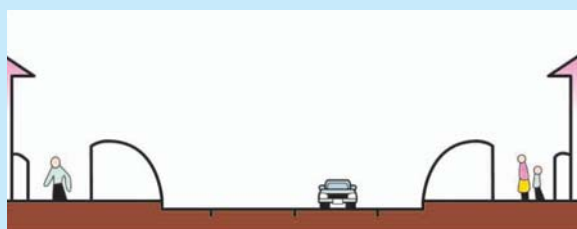
除雪された歩道
