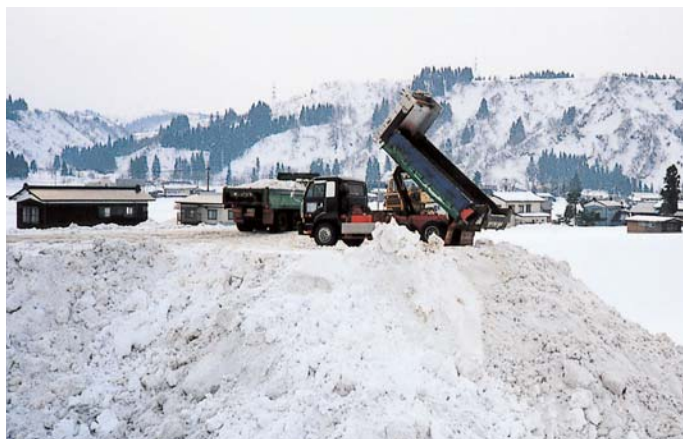
ダンプトラックによる雪捨て作業
