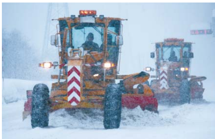
除雪グレーダによる作業
