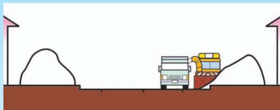
ロータリ除雪車による排雪作業
