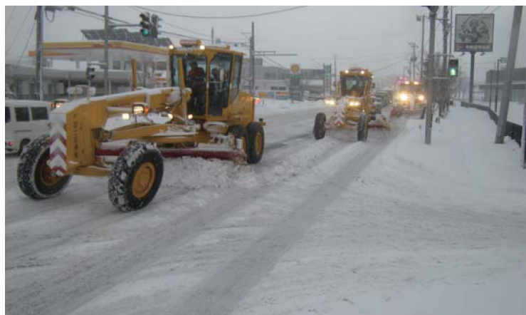
除雪グレーダによる梯団作業
