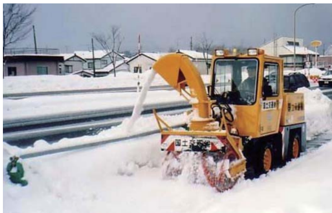
小形除雪車による作業
