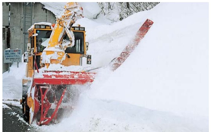
ロータリ除雪車による作業
