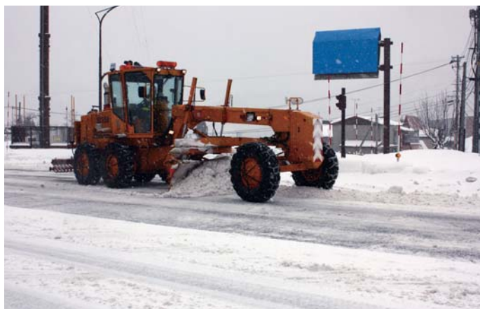
除雪グレーダによる作業
