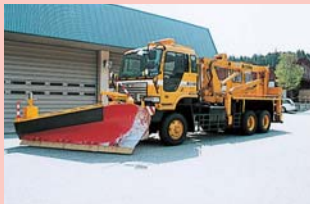
除雪トラック (雪庇処理車)
