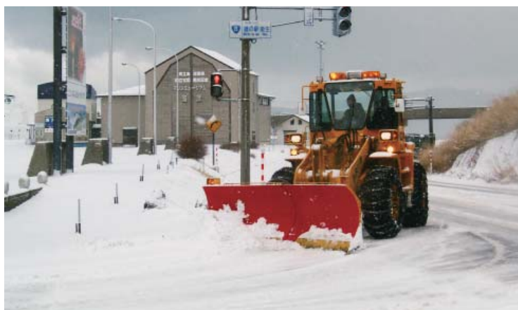
除雪ドーザによる作業
