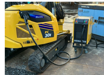
電動バックホウの充電状況
