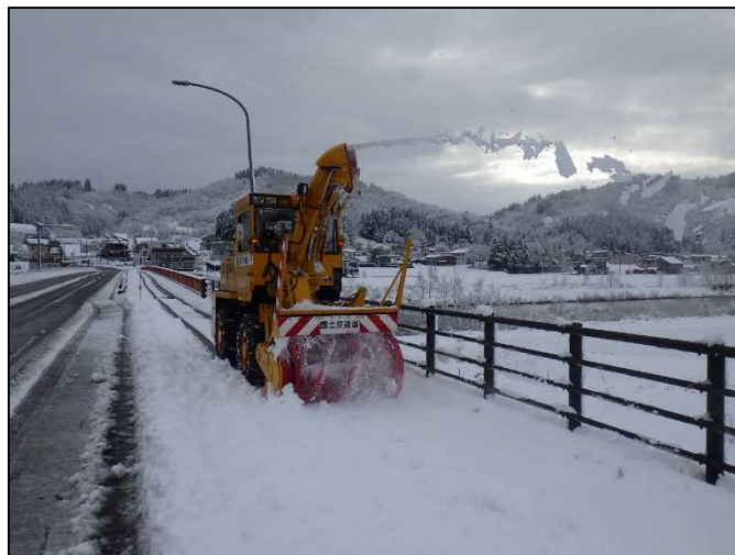
歩道除雪【国道17号 新潟県長岡市】 (R2.1.1撮影)
