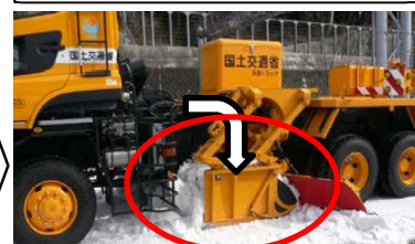
サイドシャッターで雪を抱えている状況※除雪により押しのけた雪が、交差点に残らないための装置
