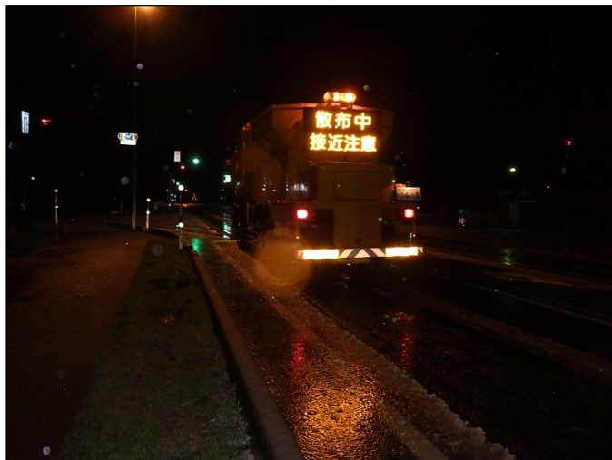
凍結防止剤散布【国道8号 富山県富山市】 (H30.11.28撮影)
