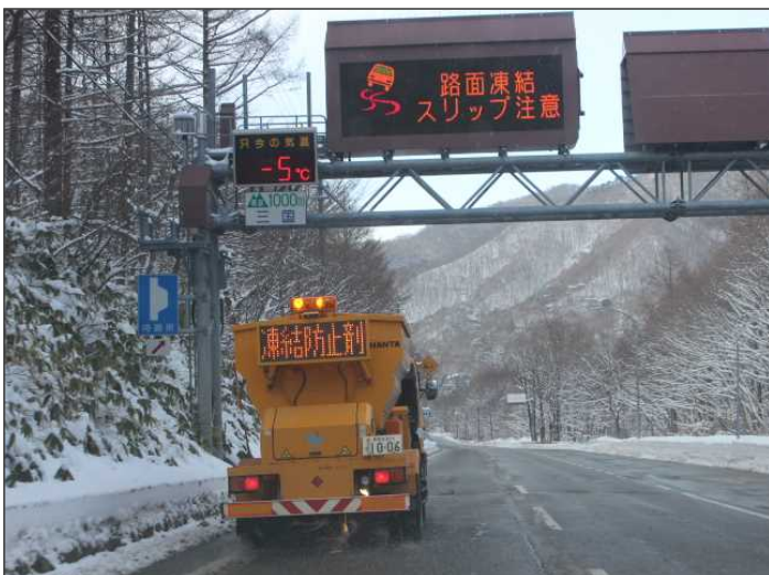
凍結防止剤散布【国道17号 新潟県南魚沼郡湯沢町】 (H28.1.19撮影)
