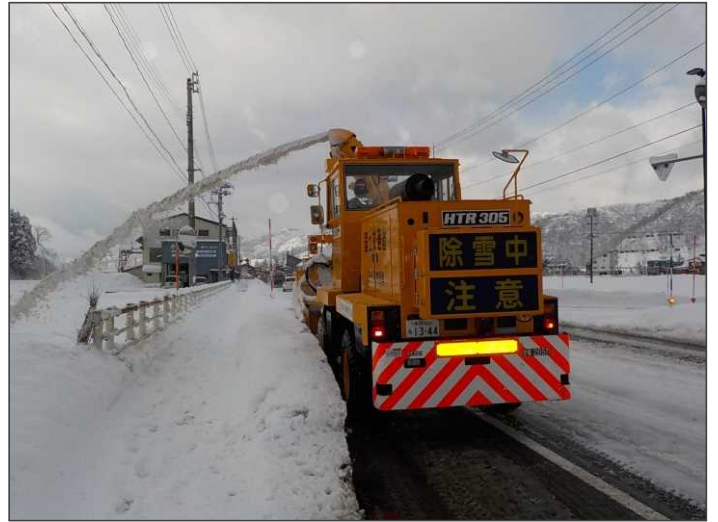
拡幅除雪【国道17号 新潟県魚沼市】 (H28.1.25撮影)
