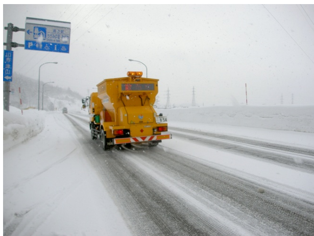
国道17号 新潟県小千谷市津山 薬剤散布状況 (H23.1.12撮影)
