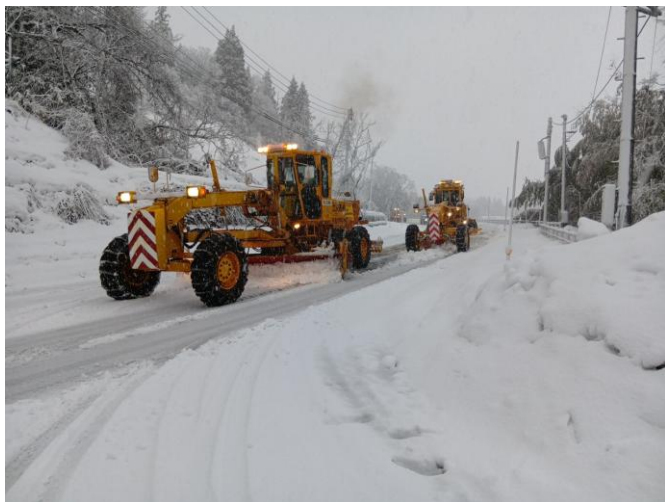
車道除雪【国道8号 新潟県長岡市】 (R8.1.11撮影)
