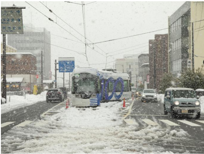
降雪の影響による脱線(富山県高岡市) (R8.1.24撮影)
