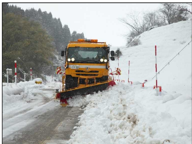
拡幅除雪【国道8号 富山県小矢部市】 (R5.1.30撮影)
