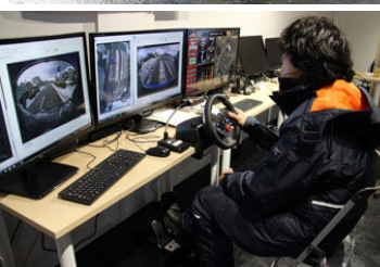
車両内完全無人での自動走行の様子（写真上） 遠隔監視・操作の様子（写真下）
