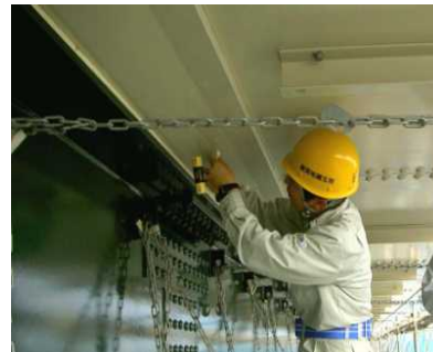
打音検査など 人間の5感に頼った検査
