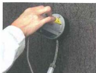
図 3.3.2 鋼材表面付着塩分測定法
