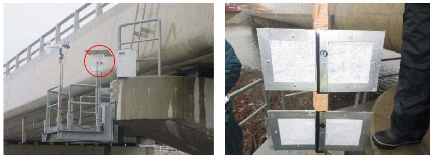
図 3.2.2 ドライガーゼ式による飛来塩分捕集
