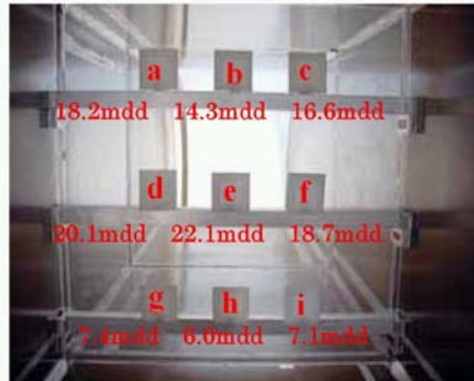
図 2.3.5 供試体配置位置及び到達塩分量
