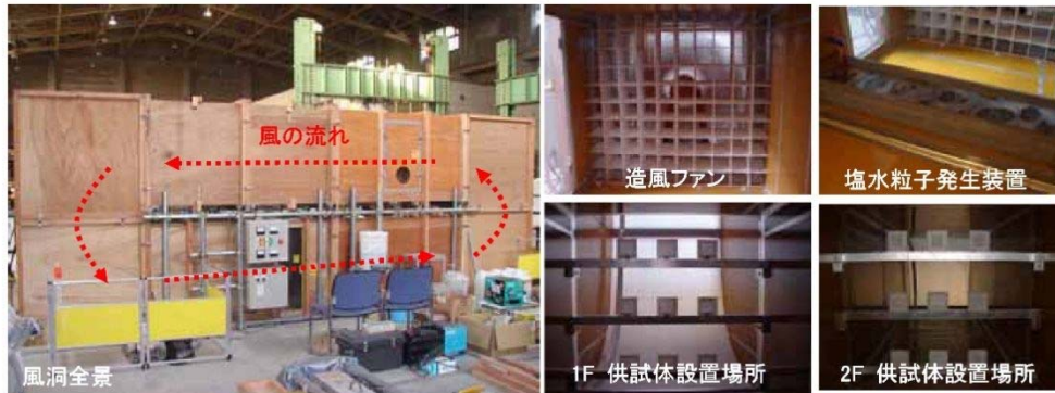
図 2.3.2 風洞外観及び内部状況
