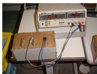
写真 4.4.2 ステンレス電極埋込
