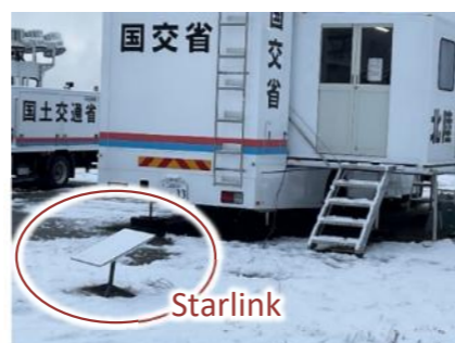
写真⑤ 民間衛星回線の設置訓練 (能登半島地震での活用状況)
