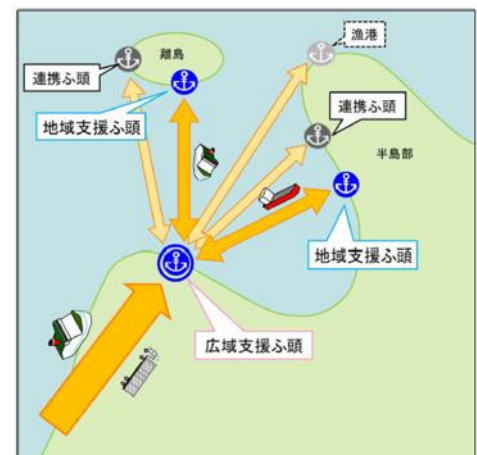
図 3.2.4 海上支援ネットワークのイメージ(広域港湾 BCP 策定ガイドライン(R7.6より))
