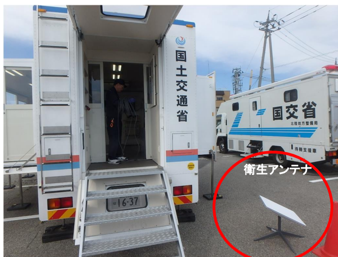
○衛生通信機器(スターリング)による通信の確保
