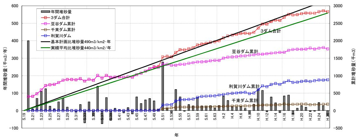
図 4.1.2 近傍ダム堆砂実績図（昭和 19 年～平成 26 年）
