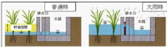
水田の排水口に小さな穴のある堰板を設置し、大雨時に水田に降った雨を一時的に溜めることで流出量を抑制することにより、浸水被害の軽減を図る。
