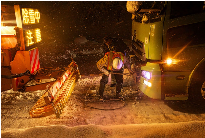
登坂不能になった大型車移動させるため 除雪車のオペレーターが除雪車と大型車を接続
