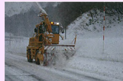
拡幅除雪作業状況
