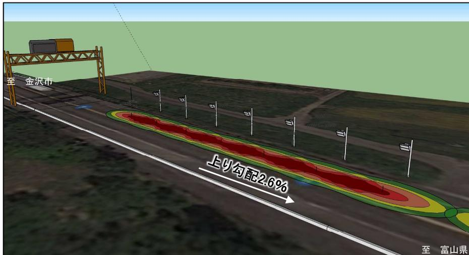
融雪装置から照射させた遠赤外線で、雪の分子を振動させ熱エネルギーに変換して融雪する装置である。
