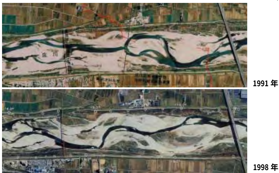
図 2.4 砂州及びみお筋の変化(庄川 14.0～16.6k 付近)
