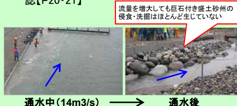
実際の滞筋に見立てた実験水路での現地実験（H23年）
