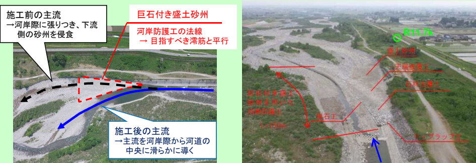
巨石付き盛土砂州を用いた河岸防護工の平面形状（滑らかな低水路河道線形の維持）
