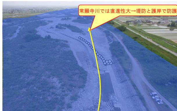
図 3.1.1 急流河川の河岸防護の考え方
