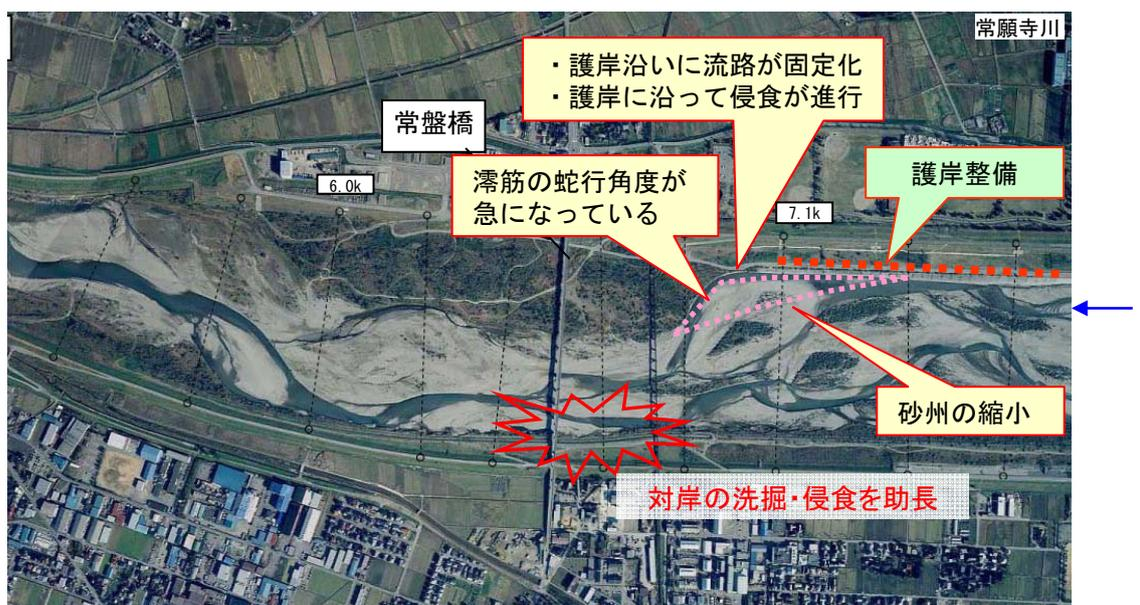
図 2.2.5 航空写真による滞筋の変遷
