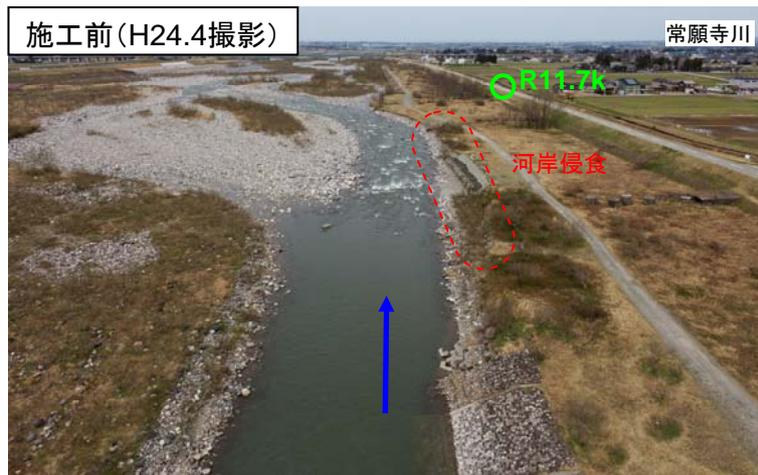
主流が河岸沿いを直線的に流下しており、河岸の侵食が進行している
