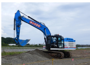
遠隔操作式バックホウ
