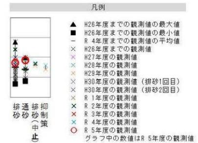
○排砂：前年度の連携排砂終了から当該年5月までに堆積した土砂を排出することを目的として6~8月に実施する。ダム流入量が出し平ダムで300m³/s、宇奈月ダムで400m³/sのいずれかを上回る最初の出水に実施する。
