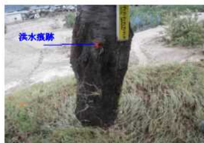
図 4.2.37 ①左岸 57.5k 地点 洪水痕跡
