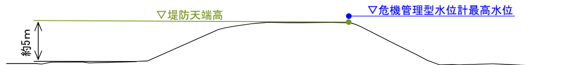
図-3 決壊箇所の越水状況(A-A断面) H25測量
