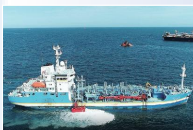
↑ 大型浚渫兼油回収船「白山」
