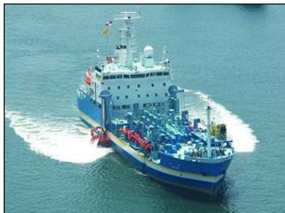
大型浚渫兼油回収船「白山」
