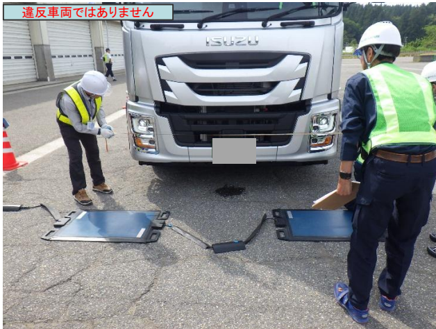
車両の寸法を計測しています。
