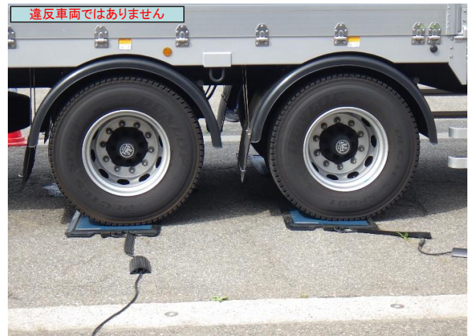
車両の重量を計測しています。
