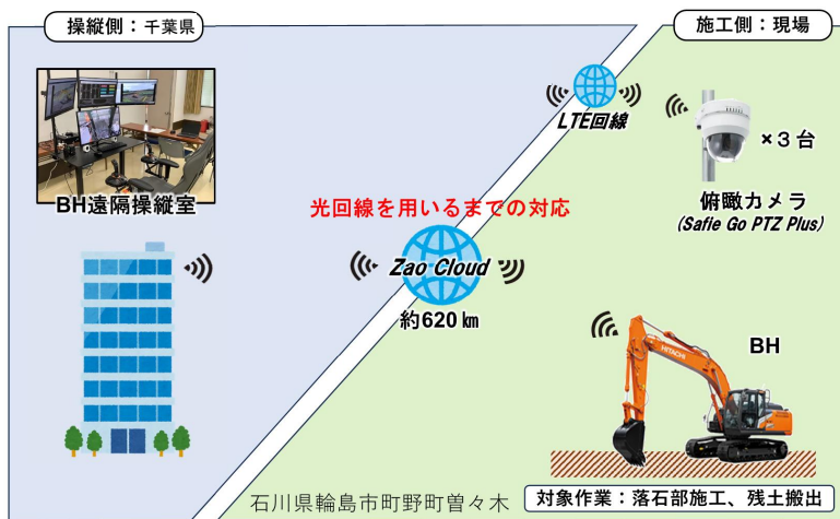
遠隔操縦概要図 ((株)大林組提供)
