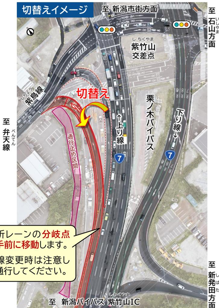
左折レーンの**分岐点**が手前に移動します。
