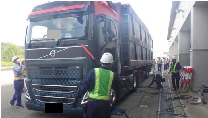
車両の重量を計測しています
