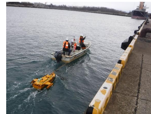
直江津港：深浅測量(ナローマルチ)の実施
