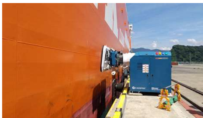
自動係留装置吸着の近景
