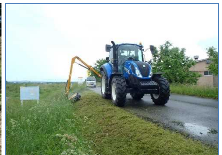
地域住民による堤防除草 （農業用機械）
