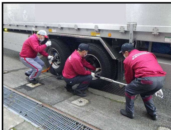
ホイール・ナットの増し締めをしています。
