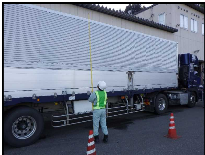
車両の寸法(高さ)を計測しています。
