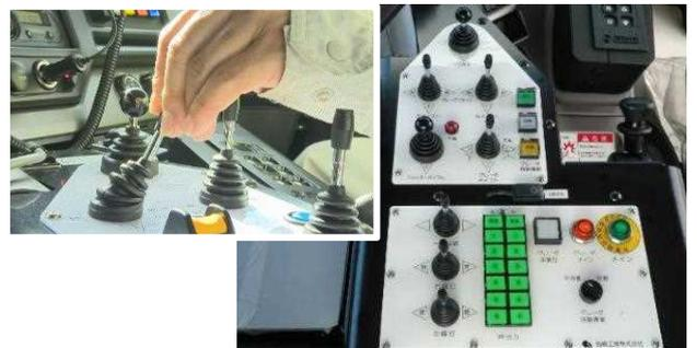
除雪トラックの「3つの装置」「5つの動作」を自動化
