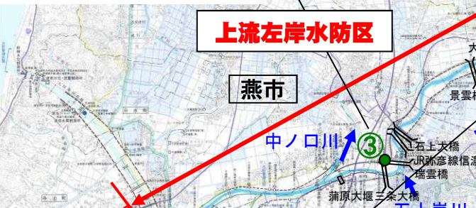
③瑞雲橋左岸(堤防高、堤防断面不足)
