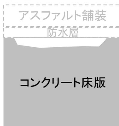
【ステップ②】 損傷部を削って取り除く
