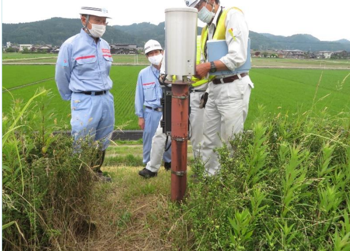
雨量計の点検
