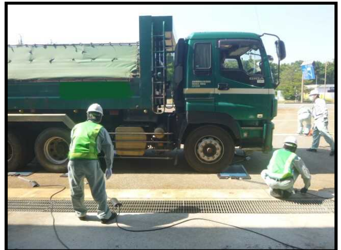
車両の重量を計測しています。
